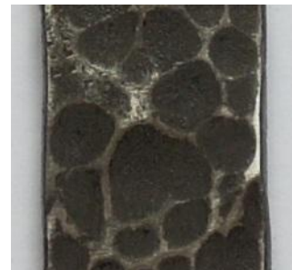
Abbildung 37: Oberfläche mit Treibhammer bearbeitet, schwarzgebrannt und geschliffen
